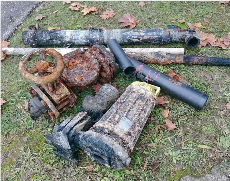
Die ausgebaute Schlammpumpe. Hat sie doch seit 1990 durchgehalten.
